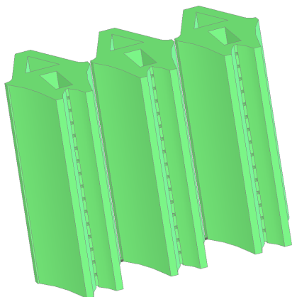
Рис.1. Фрагмент сопловой решетки в непрерывном химическом лазере
